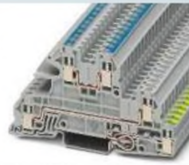
4 (4) мм 2 , 30 А, трехъярусная клемма, 1 внешний провод L, 1 провод N, 1 PE
