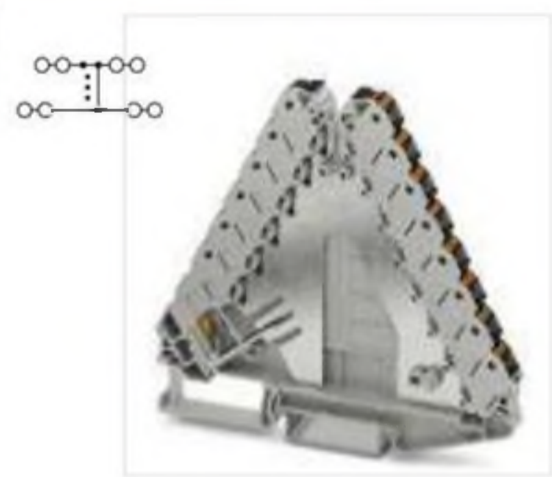
37 А, распределитель потенциалов, 29 контактов, питание, шунтируемый
