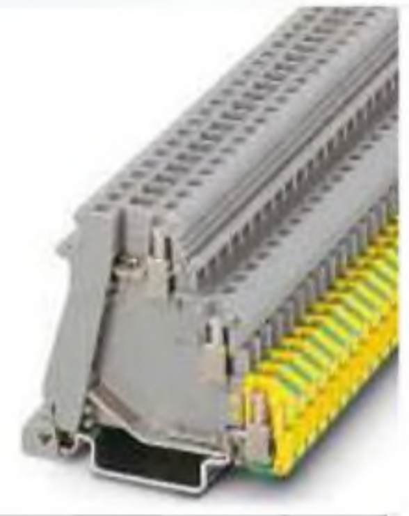
2,5 (4) мм 2 , 26 А, трехпроводная клемма для исполнительного устройства с основанием PE
