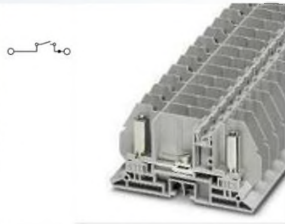
10 (10) мм 2 , 50 А, разделительная клемма измерительного трансформатора, для непосредственного монтажа
