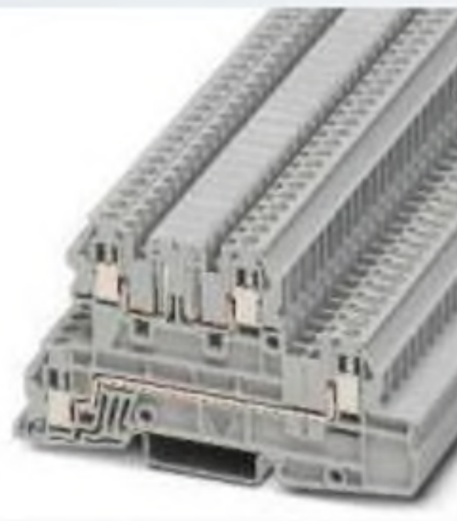
4 (4) мм 2 , 30 А, трехъярусная клемма, 2 внешних провода L
