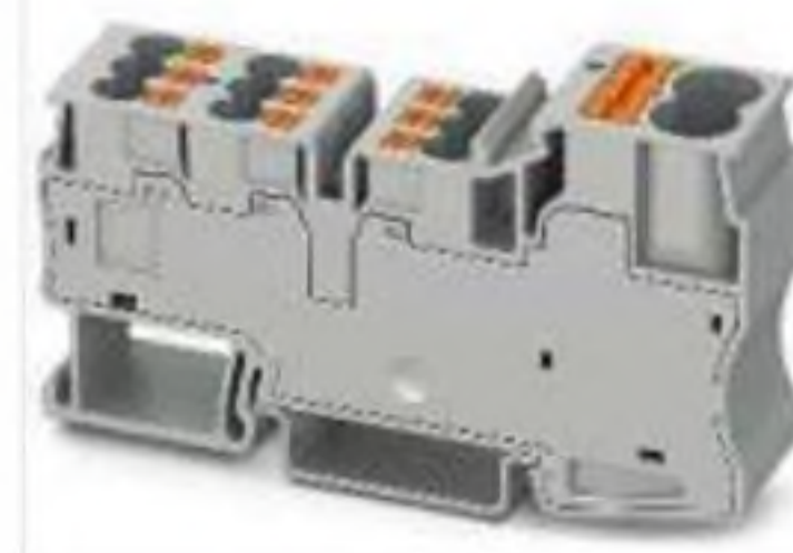
57 А, потенциальная магистральная клемма, 2 входа 10 мм 2 , 9 входов 4 мм 2
