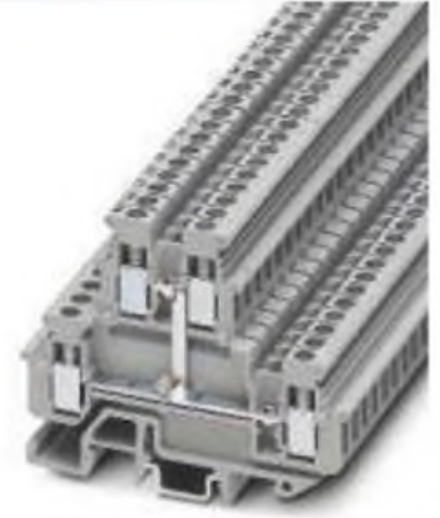
2,5 (4) мм 2 , 24 А, двухъярусная клемма с внутренним соединением ярусов
