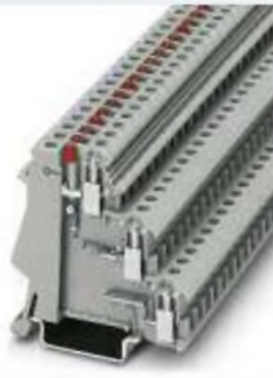
2,5 (4) мм 2 , 26 А, трехпроводная клемма со световым индикатором
