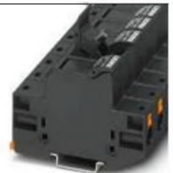
20 А, 1000 В клемма с держателем миниатюрного рычажного предохранителя 10,3 x 38 мм
