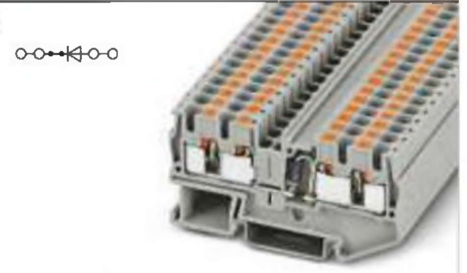
1,5 А, диодная клемма, 1N 5408 (1000 В/1,5 А)
