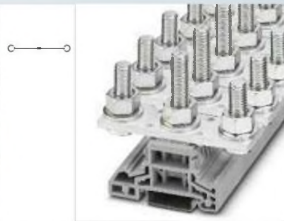
120 (120) мм 2 , 269 А, М10 болтовая клемма
