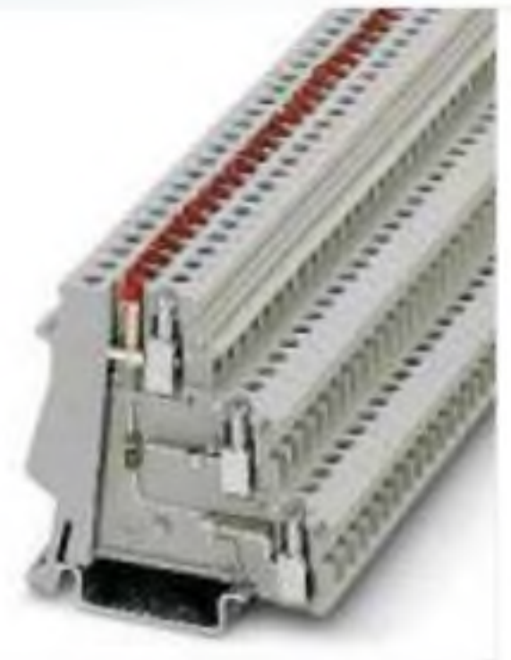
2,5 (4) мм 2 , 26 А, трехпроводная клемма со световым индикатором
