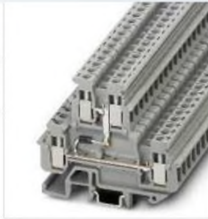
2,5 (4) мм 2 , 24 А, двухъярусная клемма, со встроенным диодом 1N 4007
