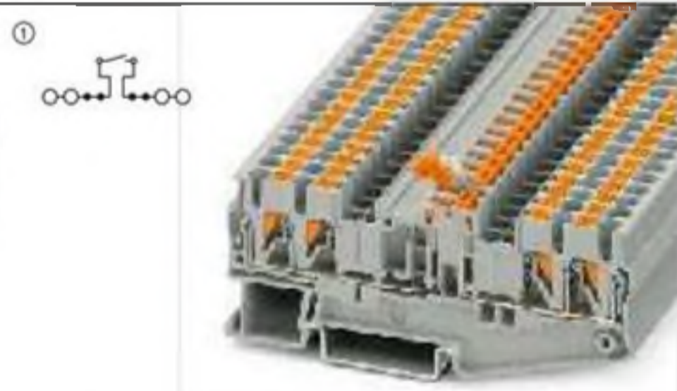
16 А, клемма с ножевым размыкателем, 4 разъема, 4 функциональных отверстия
