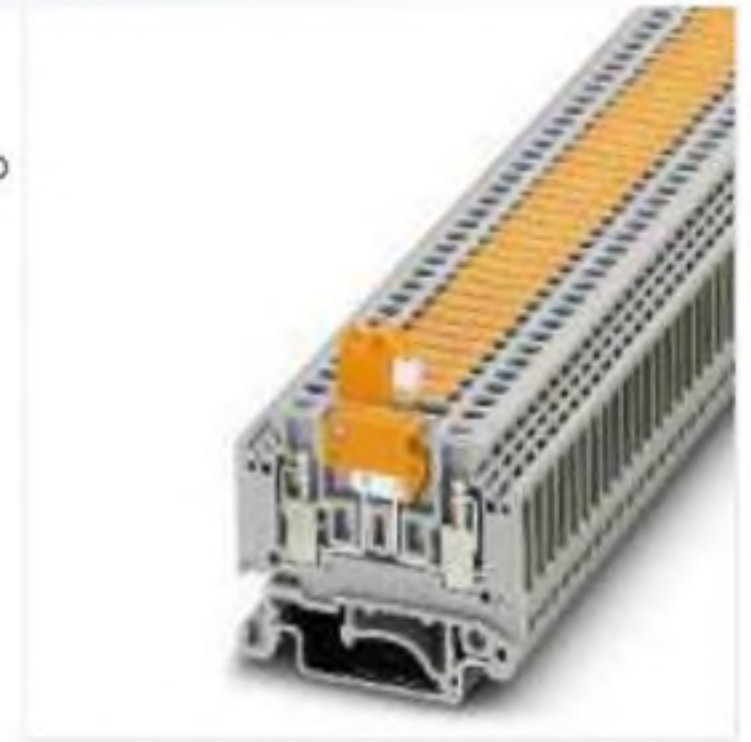
2,5 (4) мм 2 , 16 А, клемма с ножевым размыкателем
