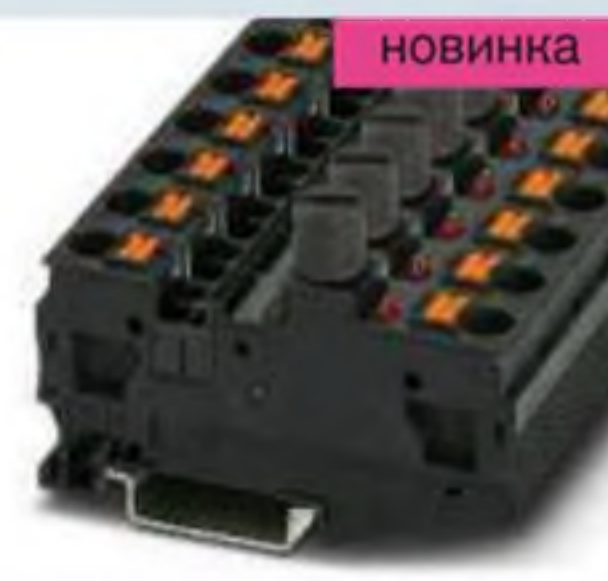
10 А, клемма с держателем предохранителя для стеклянных предохранителей 5 x 20 мм, со светодиодом
