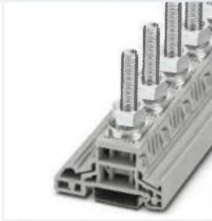
120 (120) мм 2 , 269 А, М10 болтовая клемма
