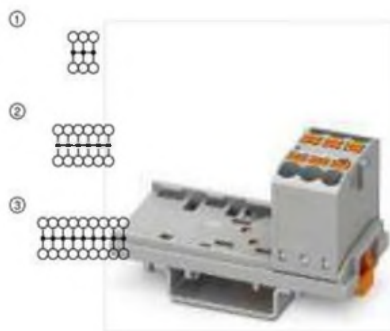
32 А, монтаж на несущую рейку NS 35 или NS 15, поперек рейки
