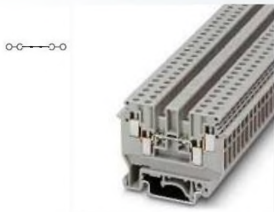
4 (6) мм 2 , 32 А, проходная клемма, 4 разъема
