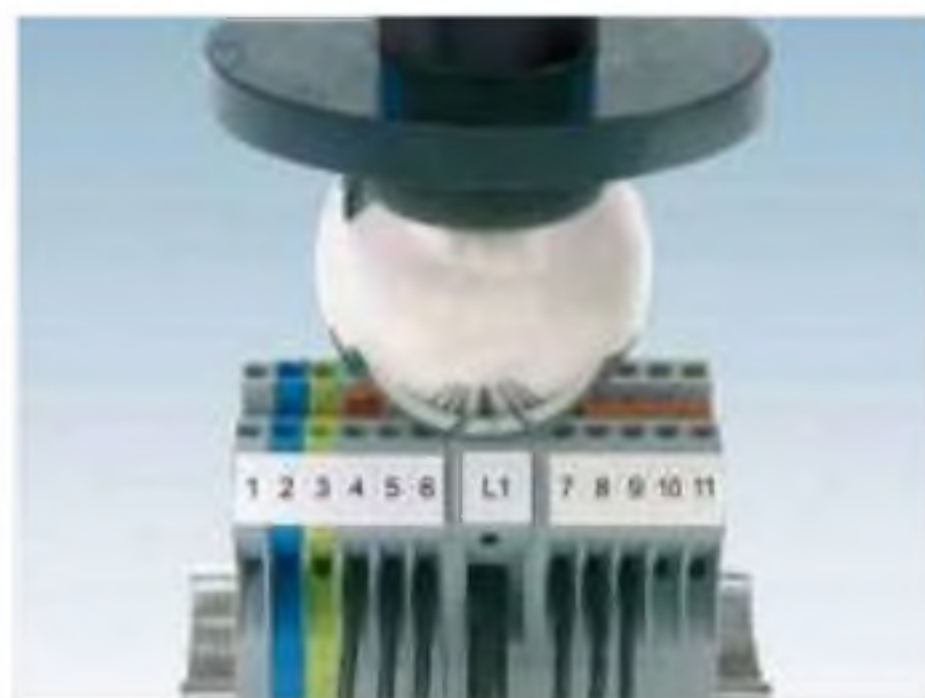
Защита от прикосновения тыльной стороной ладони Контрольный шар диаметром 50 мм
