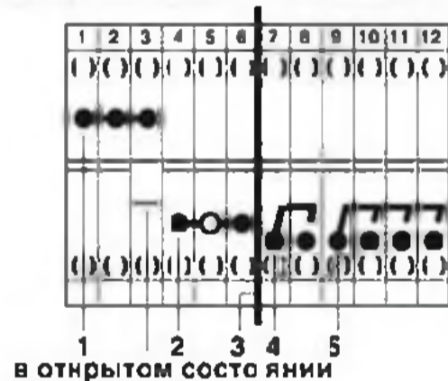
Разделительная клемма для измерительного преобразователя URTK/SP
