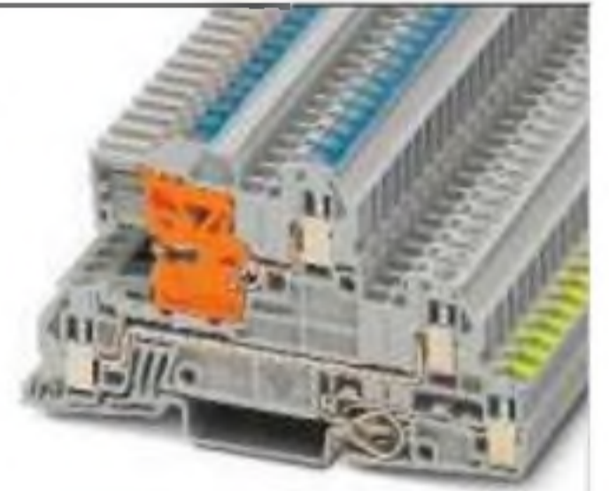
4 (4) мм 2 , 30 А, трехъярусная клемма, 1 внешний провод L, 1 провод N отделяемый, 1 PE
