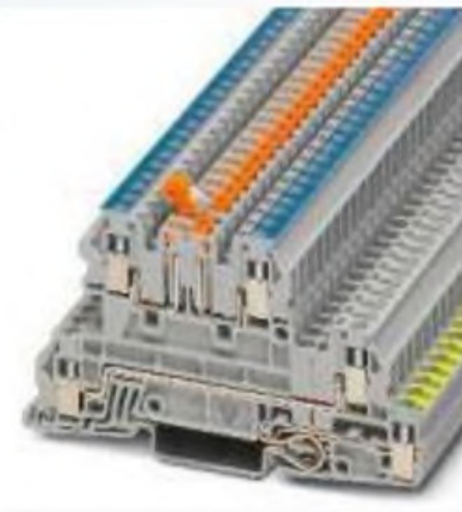
4 (4) мм 2 , 24 А, трехъярусная клемма, 1 внешний провод L, 1 провод N отделяемый, 1 PE
