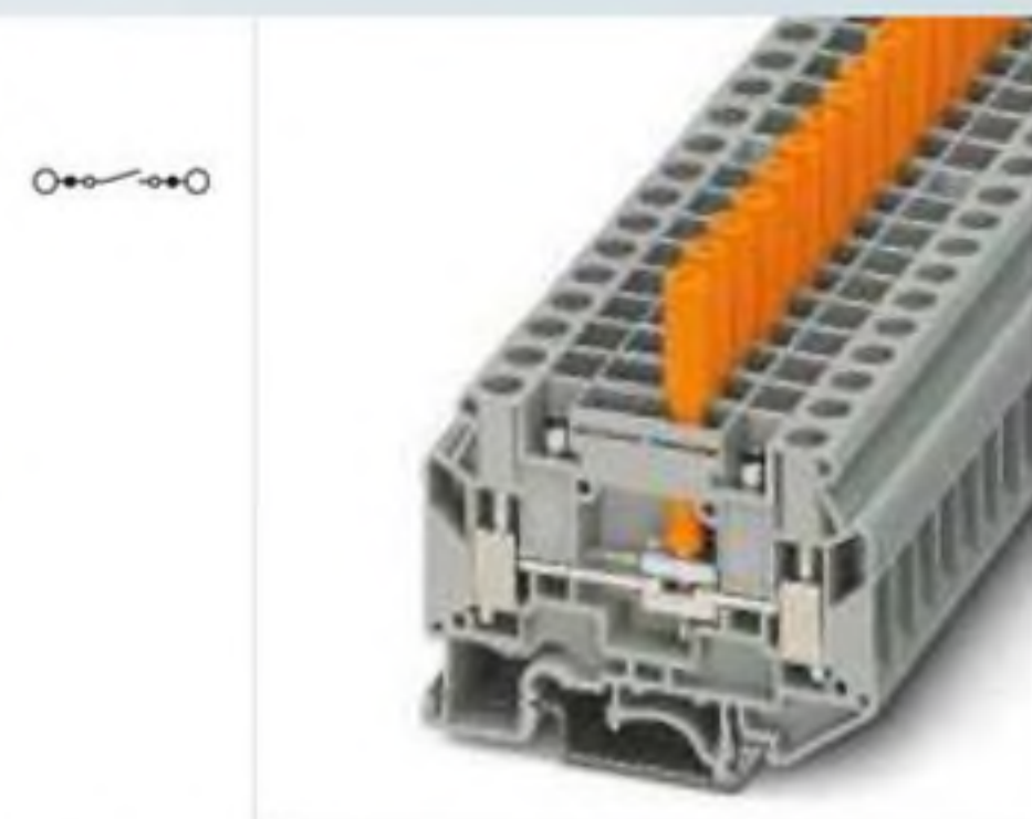
6 (10) мм 2 , 57 А, разделительная клемма
