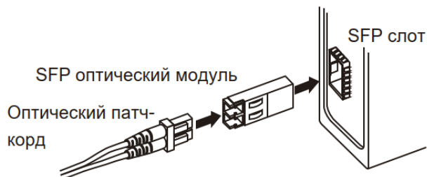
Рис. Установка SFP модуля
