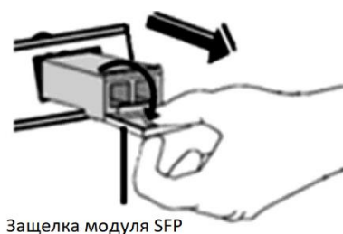
Рис. Извлечение модуля SFP
