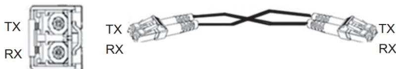
Рисунок 7. Кабельное соединение оптического гигабитного модуля SFP
