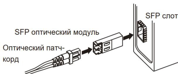
Рисунок 8. Подключение оптического модуля SFP
